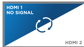
Автоматический переход на резервный источник
