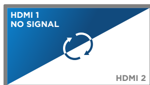
Автоматический переход на резервный источник
