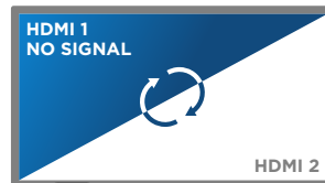
Автоматический переход на резервный источник
