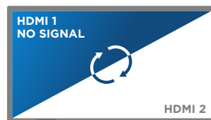
Автоматический переход на резервный источник
